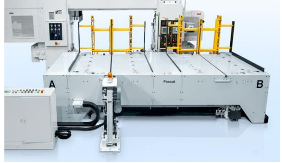
8,000 kN press — 2.8 ton × 2 dies
